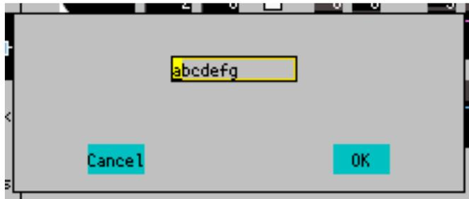
左右キーでカーソル位置を移動させます。変更したい位置で上下キーで文字を変更します。gimicDisp を利用している場合は、PC のキーで直接文字を入力することもできます。ASCII 文字のみが入力可能です。
